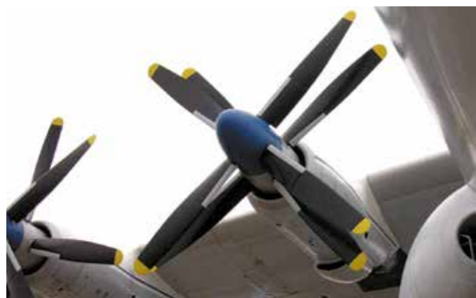
Турбовинтовой двигатель НК-12 мощностью 15000 л.с.
